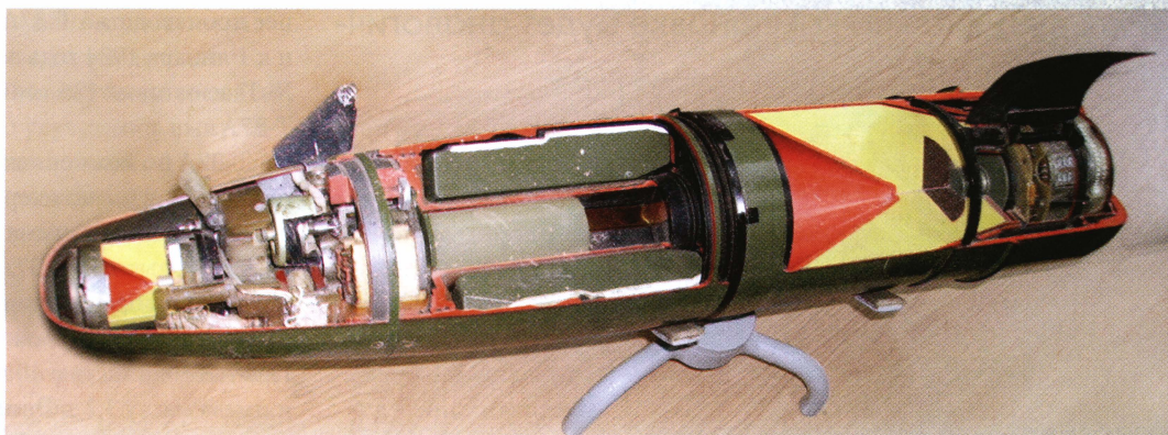
Управляемая ракета 9М119М «Инвар» в разрезе. Хорошо видно размещение лидирующего (в головной части) и основного кумулятивных зарядов.
