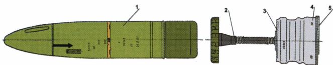
Выстрел ЗУБК14 с ракетой 9М119 комплекса управляемого вооружения «Свирь»: 1 — ракета 9М119, 2 — досылатель; 3 — метательное устройство 9Х949; 4 — поддон; 5 — перемычка.
